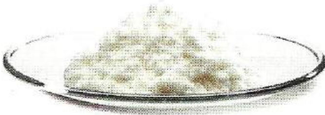
Fot. 167. Celuloza ma wzór (C_6H_{10}O_5)_n .
